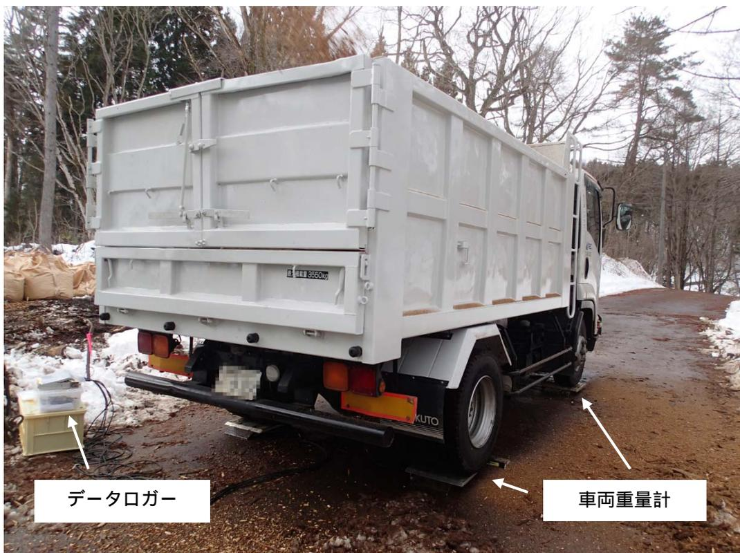
図 30 トラックと車両重量計の設置状況
