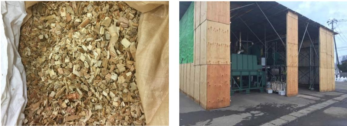
図 28 (左) 使用した製材端材チップ、(右) 使用した乾燥設備 (初回乾燥に利用 )
