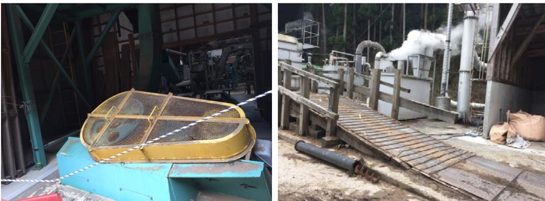
図 39 (左) チッパー (ディスク型)、(右) 木材乾燥設備
