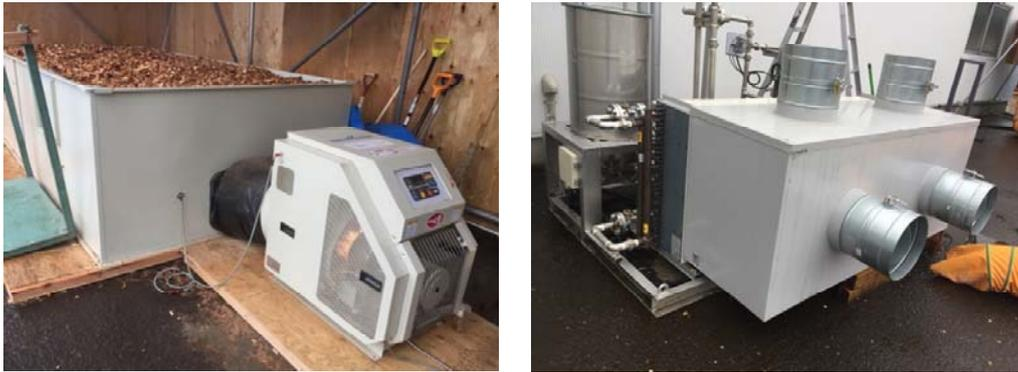
図 78 (左) バッチ式・通風乾燥、(右) 放熱器 (ダクト口付き)
