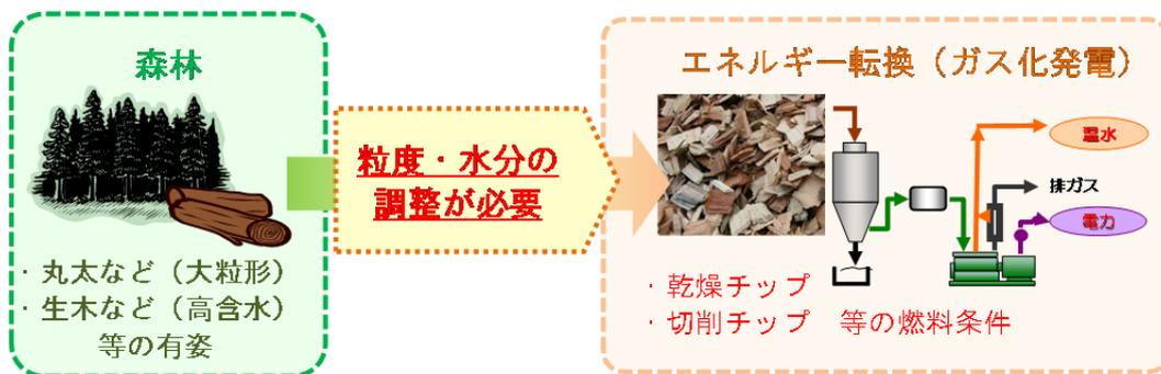
図 8 森林現場で発生する原料とプラント側で求められる性状との差の概念図
