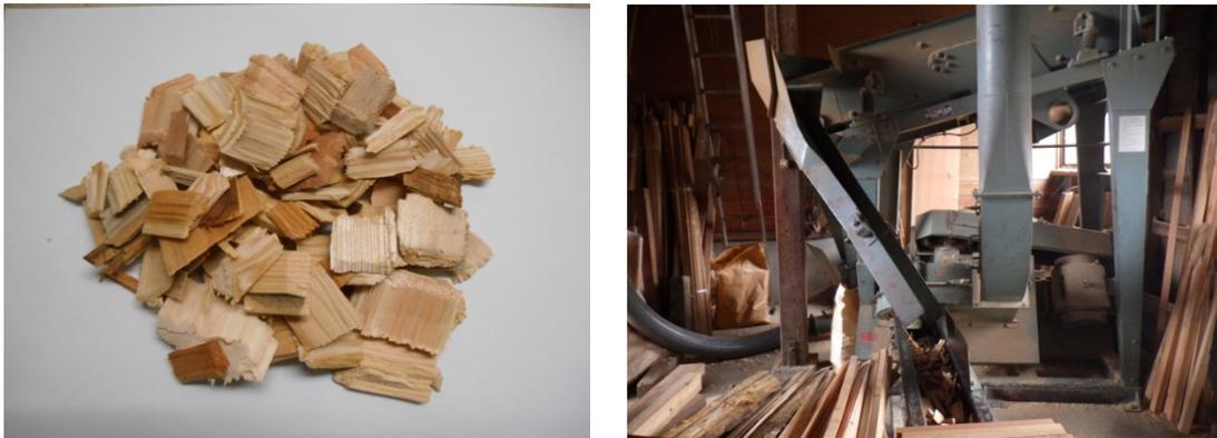
図 103 (左)チップ外観例、(右)チップ化設備
