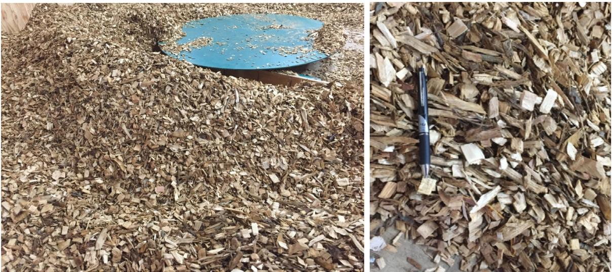
図 31 (左) 使用した試験用燃料 (現地破碎チップ)、(右) 同拡大
