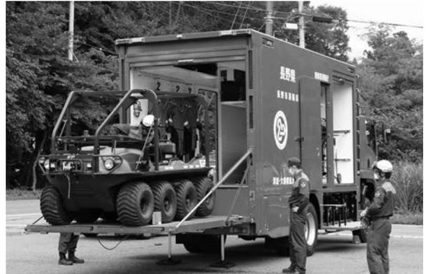
大規模風水害対策車に小型水陸両用バギーを格納している様子
