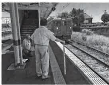
電車とホームの段差を計測中
