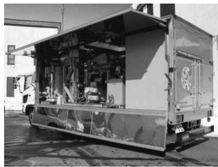
移動式汚泥脱水乾燥車 通称:コンポスト車
