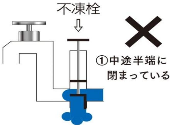
① のように、不凍栓が中途半端になっていますと、水が漏れてしまいます。
