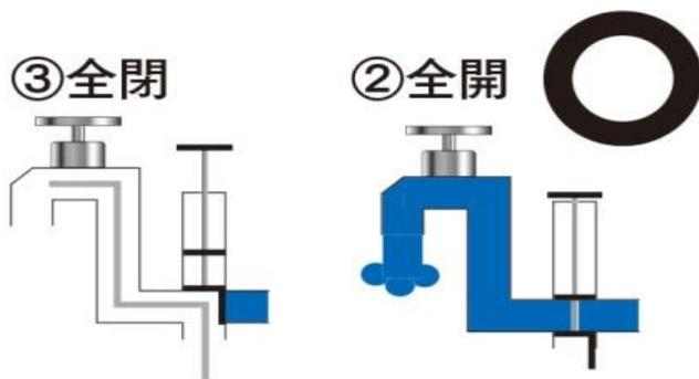
② の「全開」または③の「全閉」の状態にしないと水抜き穴に水道水が漏れてしまいます。ご注意ください。
